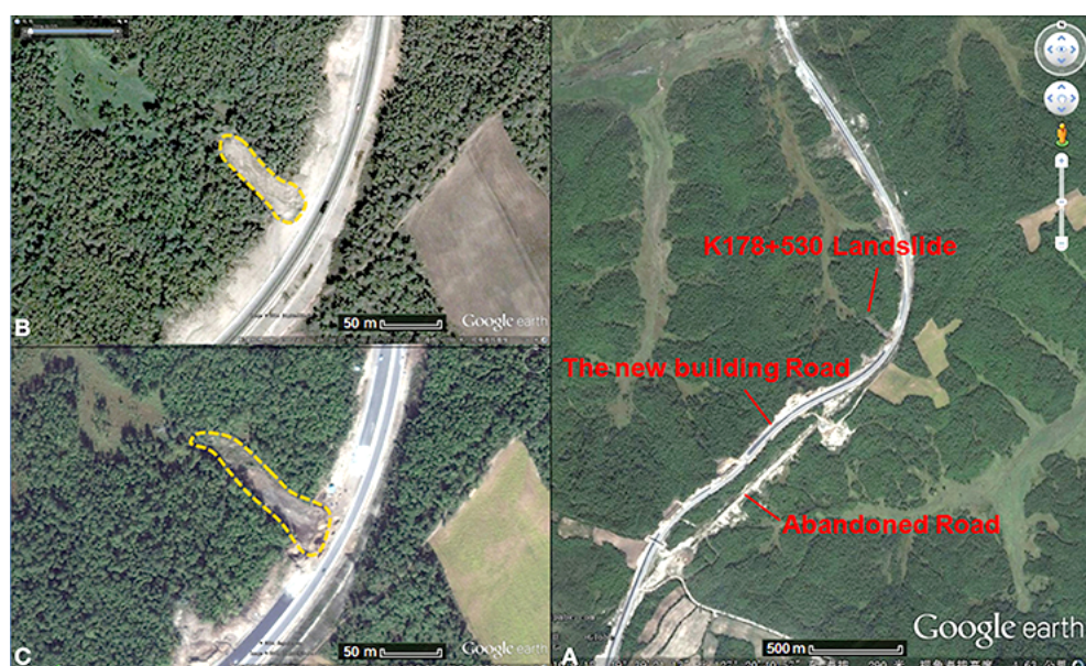
Рис. 15. Спутниковые фотографии разреза K176 + 500 — K179 + 900 шоссе Бэйань-Хэйхэ [Shan Wei et al. 2015]: (А) Оползень на K178 + 530 (2000 г.). (В) Спутниковые фотографии K178 + 530 (2004, июнь). (С) Спутниковые фотографии K178 + 530 (2010, сентябрь).
