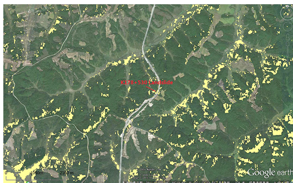
Рис. 16. Карта распределения многолетнемерзлых пород разреза K176 + 500 — K180 + 000 шоссе Бэйань-Хэйхэ [Shan Wei et al. 2015]
